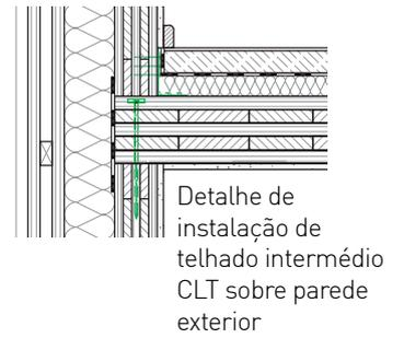
Detalhe de instalação de telhado intermédio CLT sobre parede exterior
