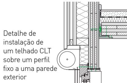
Detalhe de instalação de um telhado CLT sobre um perfil fixo a uma parede exterior
