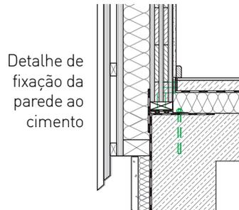
Detalhe de fixação da parede ao cimento
