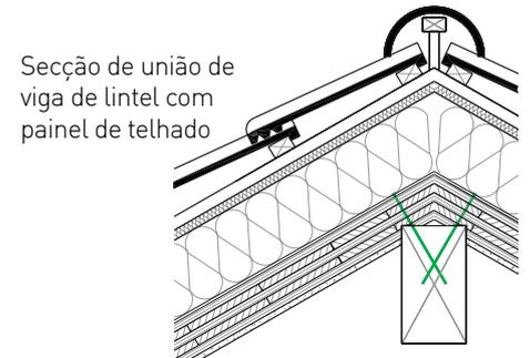
Secção de união de viga de lintel com painel de telhado
