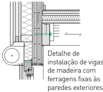
Detalhe de instalação de vigas de madeira com ferragens fixas às paredes exteriores
