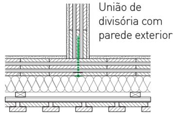
União de divisória com parede exterior
