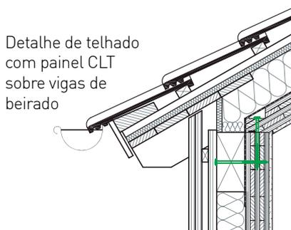
Detalhe de telhado com painel CLT sobre vigas de beirado
