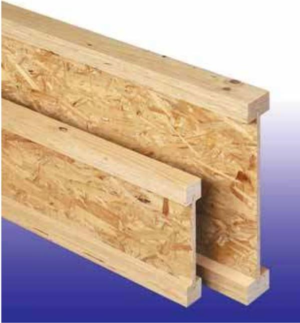
As vigas Finnjoist, com banzos em Kerto-S (LVL) e alma em OSB, têm um ratio mais elevado de resistência para peso, e como consequência, permitem vencer vãos maiores e, dada a sua leveza, são de muito fácil instalação, reduzindo o tempo de construção e aumentando a eficiência.
