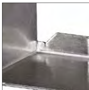
Proteção para evitar o desdobramento
