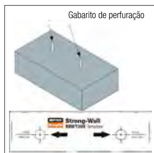
Etapa 1 Colocação das hastes roscadas
