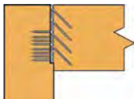
Montagem visível sem rebaixamento.
